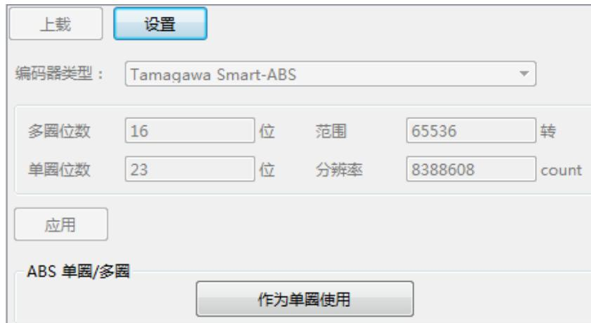
图 7-9 多摩川绝对值作为多圈使用
